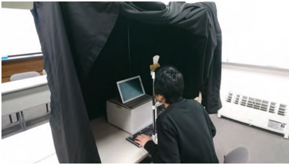
図7 実験室環境における実験装置の様子。実験時には実験参加者と暗幕で被覆する。
